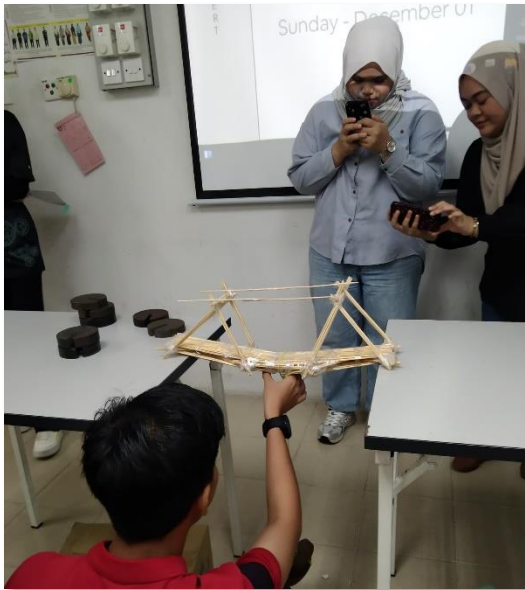
Sesi ujian ketahanan daya pada struktur
