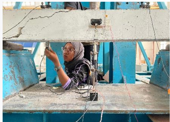
Pengesanan kecacatan pada rasuk menggunakan MMM
